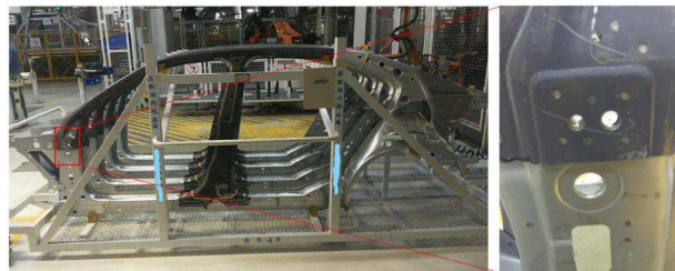
图 2 侧围内板 A 柱上加强板与 A 柱下加强板间的点焊焊点
