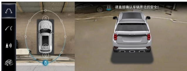
图1 汽车中控显示屏全景影像状态显示
