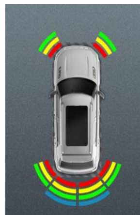
图2 雷达警示线显示
